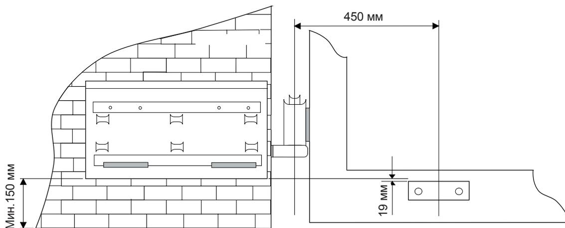
Установите привод на монтажное основание и закрепите двумя болтами М8х110 с гайками М8 (поставляются в комплекте).
