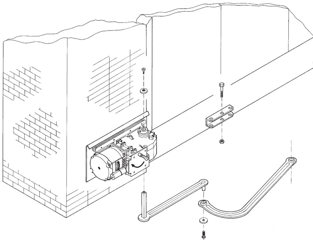
Вставьте прямой рычаг в отверстие вала редуктора, закрепите болтом М6х20 с шайбой и зафиксируйте стопорными винтами. Соедините два рычага болтом М8х16 с шайбой. Разблокируйте редуктор, повернув ручку разблокировки по часовой стрелке и прикрепите изогнутый рычаг к скобе "А" болтом М12х50 с гайком М12.
