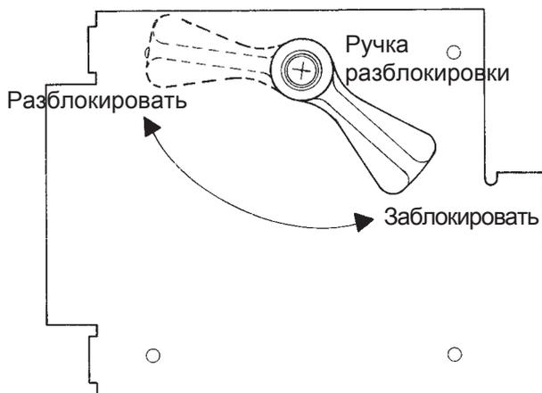
**⚠ Разблокировку/блокировку выполнять только при неработающем двигателе!**
