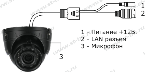
Рис. 1 Схема подключения видеокамеры
