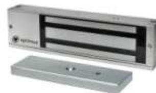
Рабочее напряжение электрозамка составляет 12В/24В. Потребляемый ток - 500мА/250мА. Предназначен для довольно тяжелых наружных дверей, сила удержания 450 кг. ±10%. Работает при температуре от -40°С до +50°С, вне зависимости от влажности и возможных перепадов температур.
