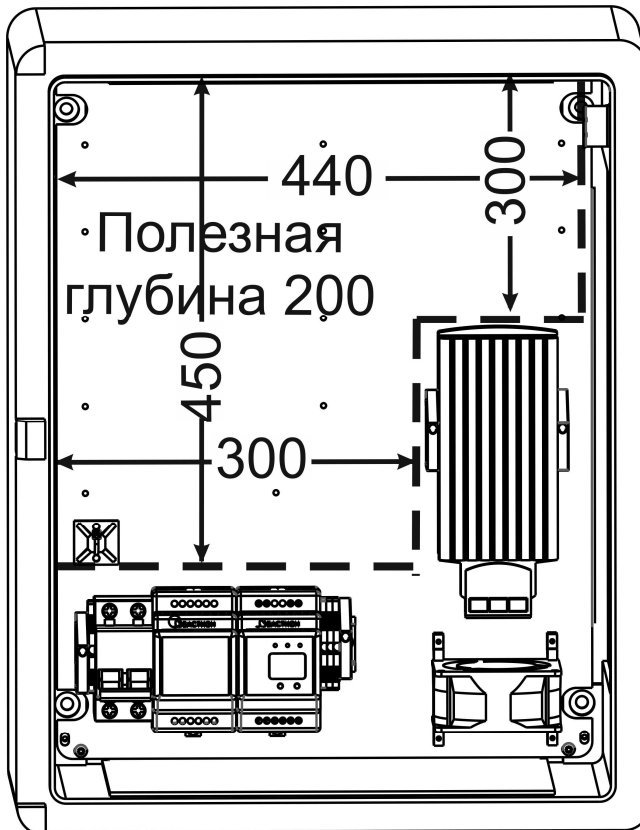
Рисунок 1 – Пространство внутри для установки доп. оборудования
